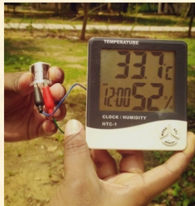
चित्र 4. हमारे द्वारा बनाई एक छोटी ( 6.2 \text{ cm}^2 ) लचीली सौर सेल द्वारा एक LCD Display को सूर्य की रोशनी में चलना।
